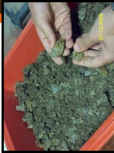
2) brassage, démottage, homogénéisation, quartage
