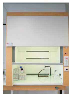
Figure 4 : photo d'une sorbonne à registre (source : équiplabo.fr)
